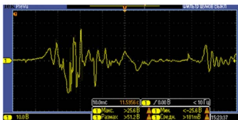
Рисунок 18 – Типовая осциллограмма напряжений для образцов песчаника при динамическом приложении нагрузки
