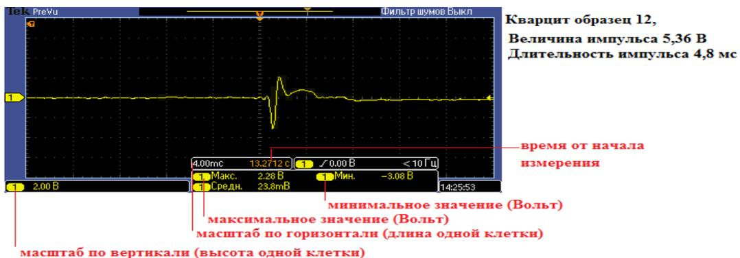
Рисунок 6.21 – Осциллограмма напряжений при испытании образца кварцита № 12
