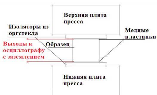
Рисунок 6.16 – Схематичное изображение измерения пьезоэлектрического эффекта образцов при нагружениях горных пород, близких к статическим
