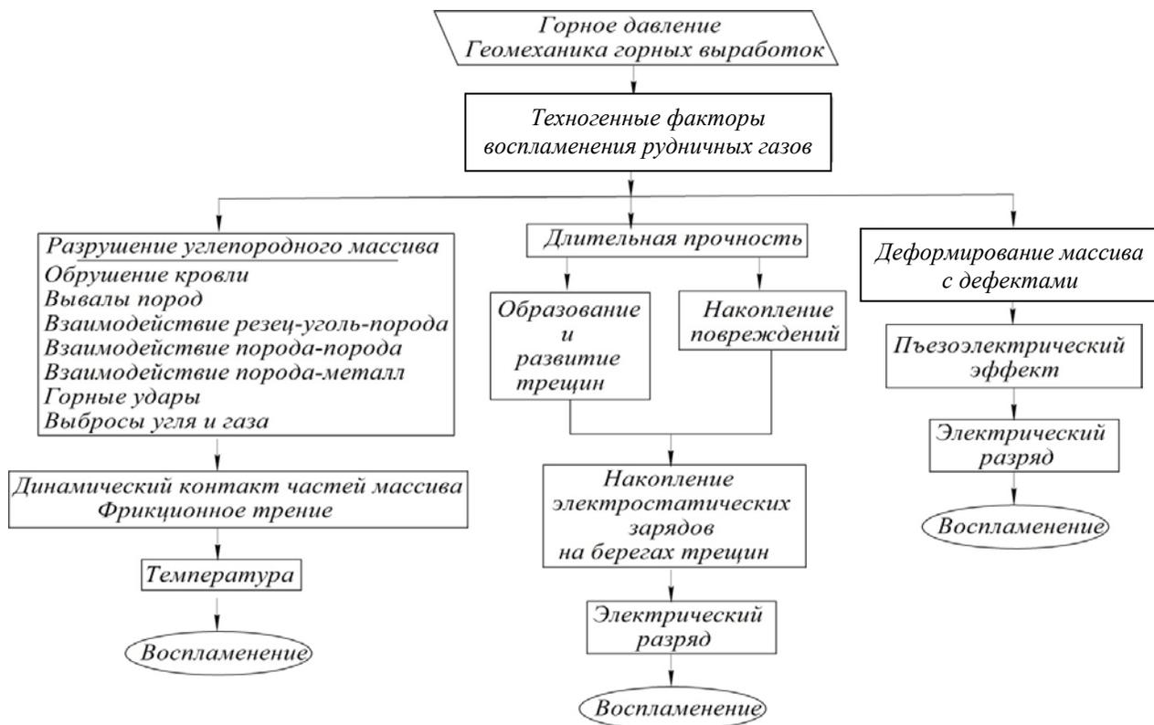
Рисунок 1.2 – Техногенные факторы воспламенения рудничных газов
