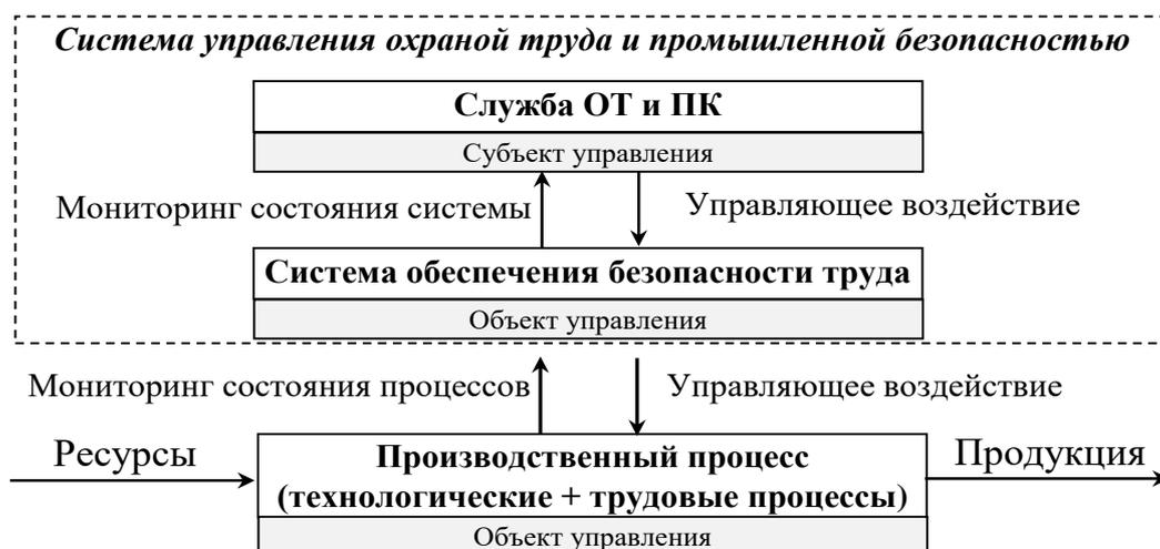
**Рисунок 5 – Схема управления безопасностью труда**
