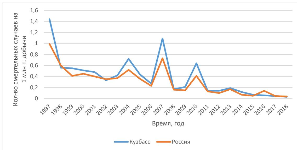
Рисунок 1.5 – Количество смертельных случаев, приходящихся на 1 млн т. добычи угля.
