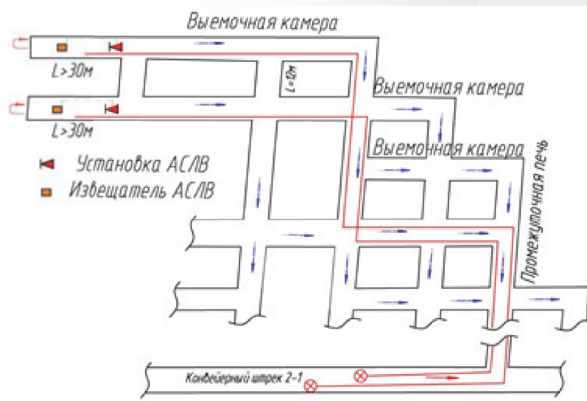
Рисунок 3 – Схема установки АСЛВ в подготовительной выработке длиной более 30 м
