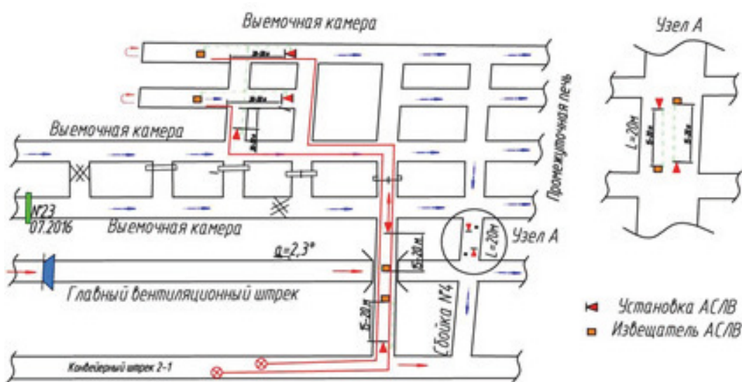
Рисунок 6 – Схема установки АСЛВ при изоляции участка КСО
