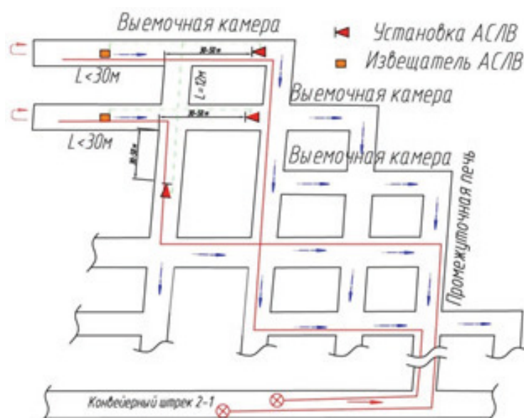
Рисунок 2 – Схема установки АСЛВ в подготовительной выработке длиной не более 30 м
