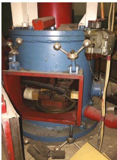
Рисунок 5 – Взрывная камера ВостНИИ для испытаний поврежденного кабеля
