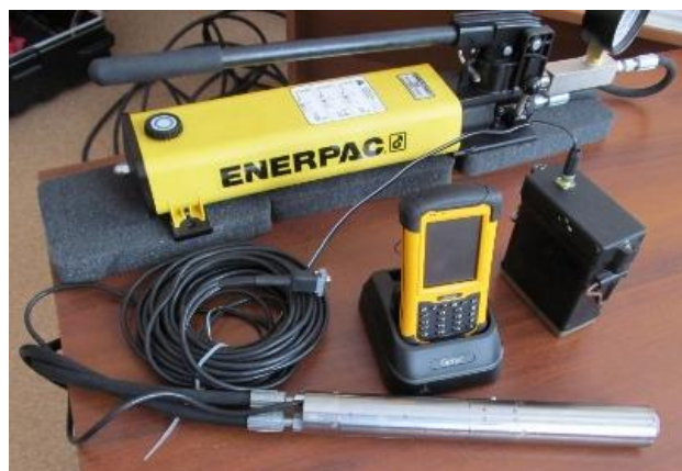
Рис. 1. Пинометр: зонд, компьютер, гидравлический насос, аккумулятор
