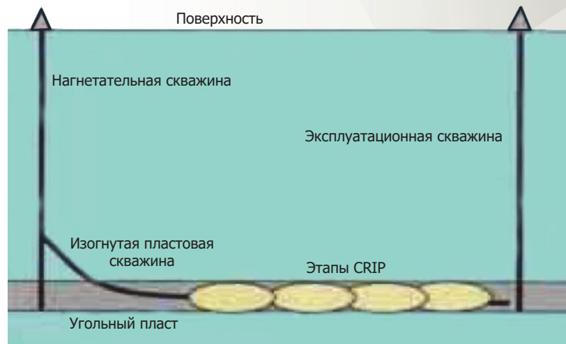
Рис. 8. Базовая конфигурация одиночной скважины для UCG
