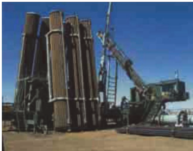
Рис. 5. Буровой станок направленного бурения фирмы SASOL
