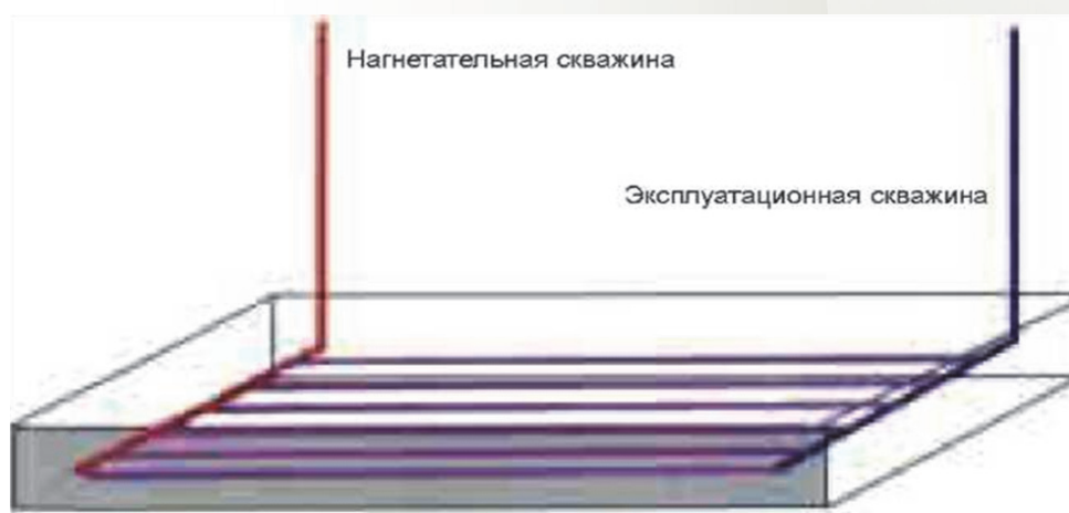
Рис. 10. Направленное бурение для UCG
