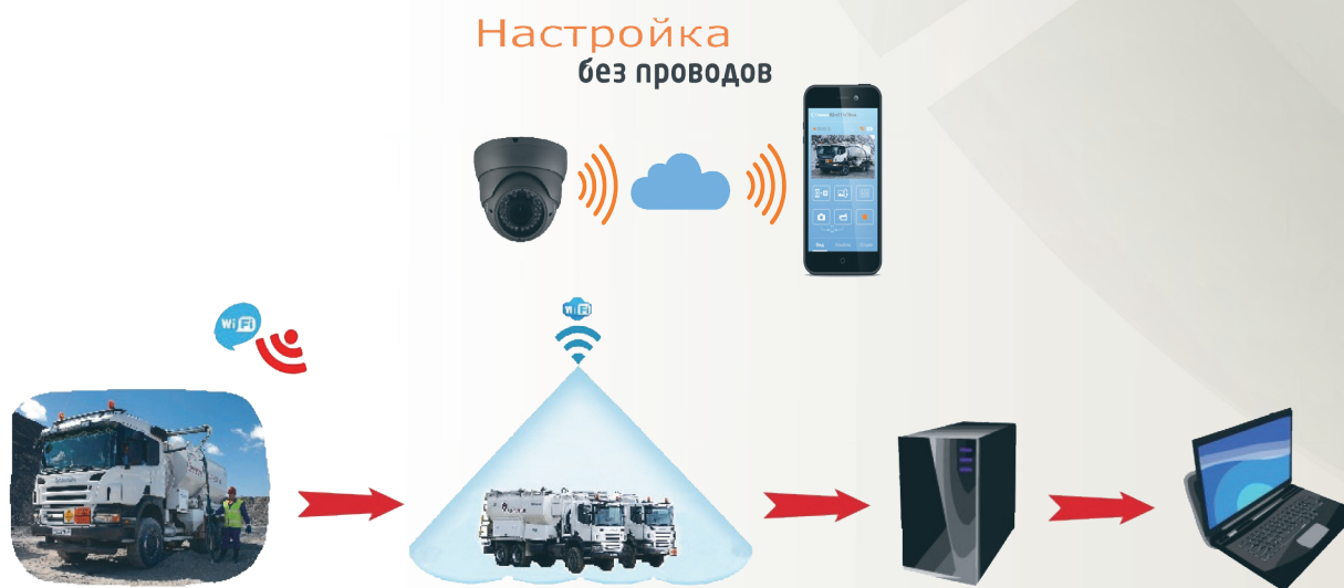
Рис. 9. Система видеонаблюдения на СЗМ, контроль за соблюдением технологических процессов изготовления ВВ на местах ведения работ
