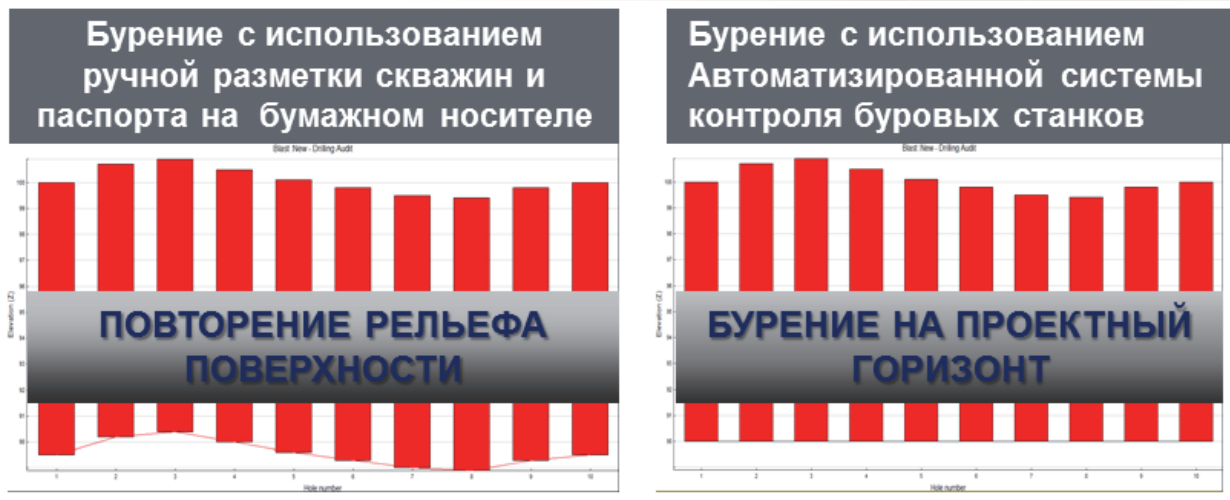
Рис. 5. Автоматическое определение глубины скважин
