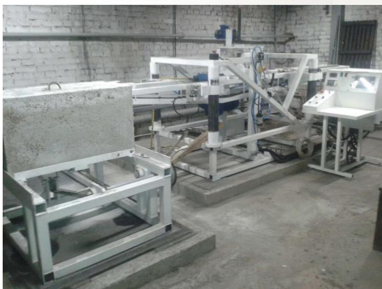
Рис. 1. Общий вид бурового станда
