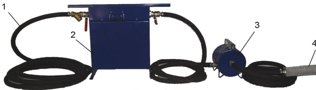
1 – подающий рукав от шахтной пневмосети; 2 – блок фильтров; 3 – блок охлаждения; 4 – рассекатель
