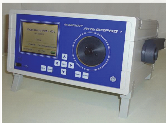
Рис. 2. Измерительный комплекс «Альфард плюс» для контроля радона, торона и их дочерних продуктов
