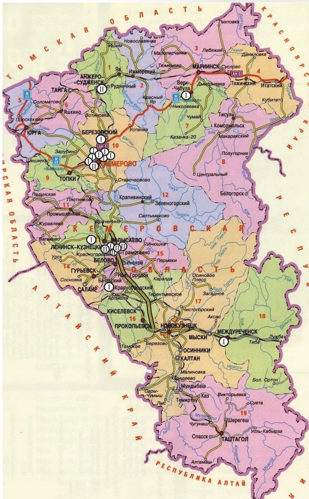
Рис. 3. Результаты замеров плотности потока радиоактивного газа радона с почвы на территории Кемеровской области компанией ООО «НООСТРОЙ»: I–III – классы опасности участка по концентрации радона
