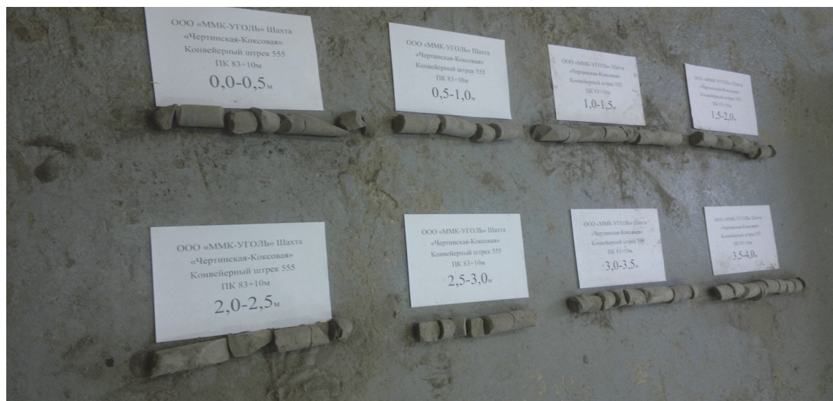
Рис. 4. Образцы пород керна кровли конвейерного штрека 555 ПК 83+10 м
