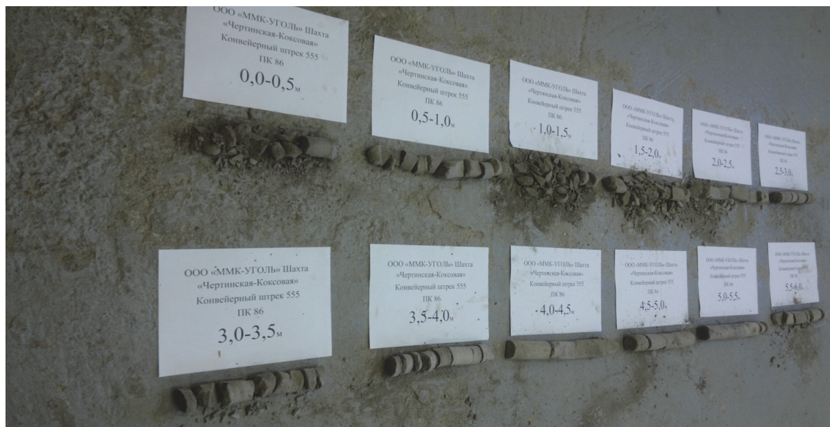
Рис. 3. Образцы пород керна кровли конвейерного штрека 555 ПК 86
