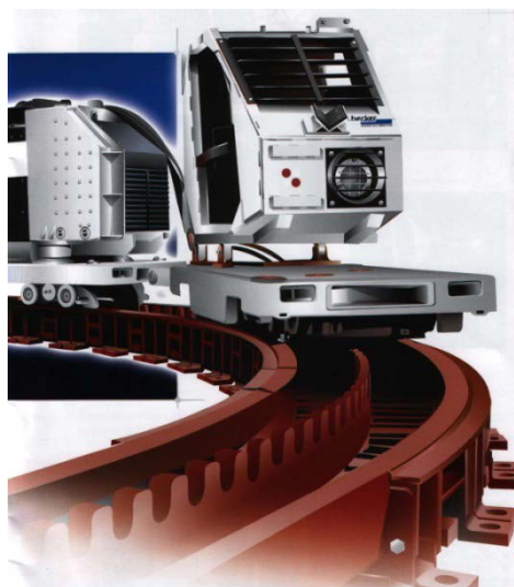
Рис. 2. Напочвенная реечная дорога с дизельным приводом
